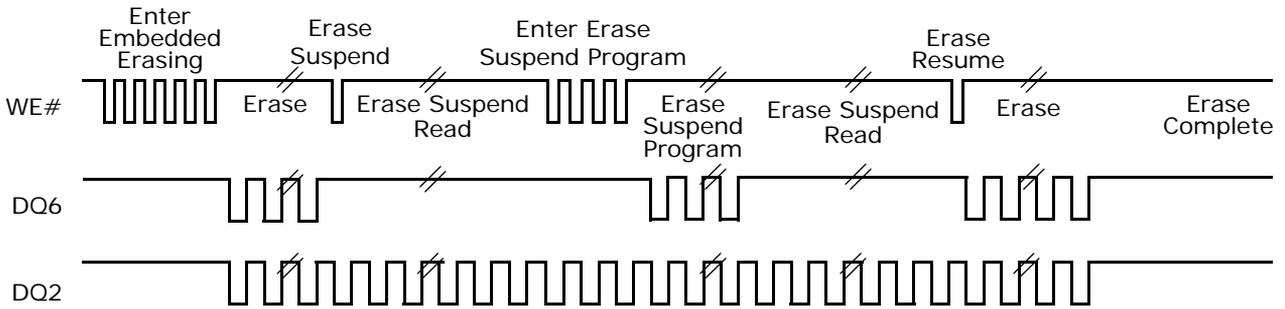
**Note:** DQ2 toggles only when read at an address within an erase-suspended sector. The system may use OE# or CE# to toggle DQ2 and DQ6.
