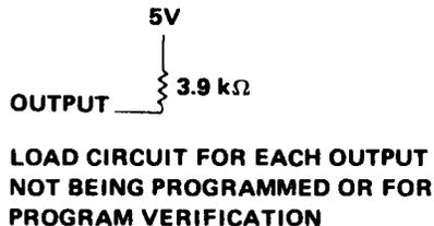
**FIGURE 1 – LOAD CIRCUIT**
