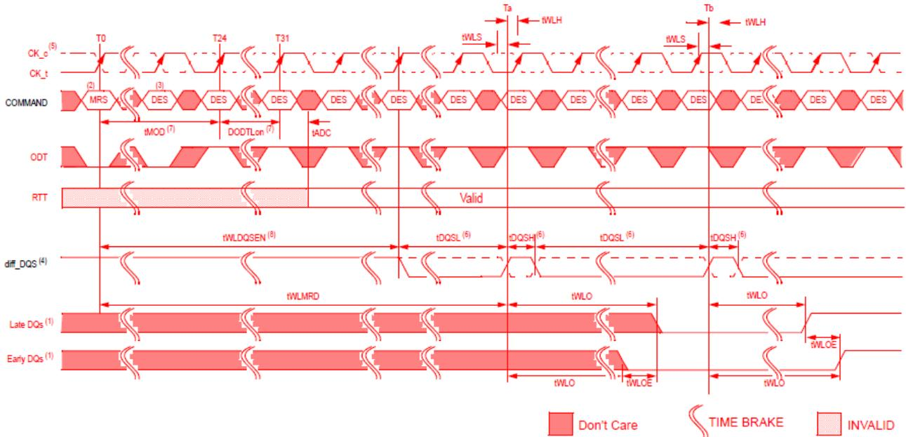
NOTE 1 DDR4 SDRAM drives leveling feedback on all DQs
