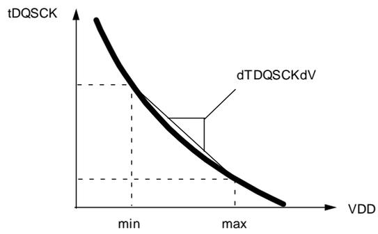
$$dTDQCKdV = |t_{DQCK}(V_{DD,max}) - t_{DQCK}(V_{DD,min})| / |V_{DD,max} - V_{DD,min}|$$
