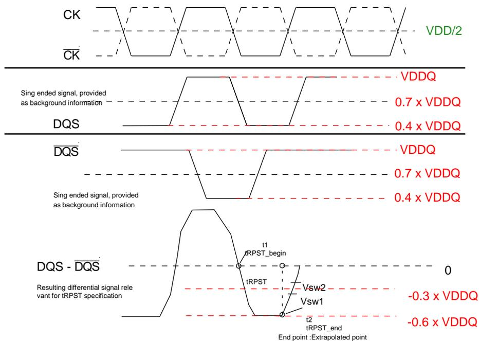
NOTE 1 Low Level of DQS and  $\overline{DQS} = V_{DDQ} / (50+34) \times 34 = V_{DDQ} \times 0.40$
