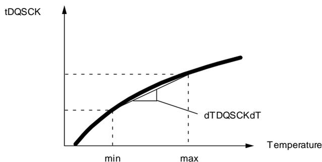
$$dTQSKdT = |tDQSK(T_{oper,max}) - tDQSK(T_{oper,min})| / |T_{oper,max} - T_{oper,min}|$$
