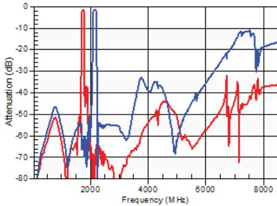
**Figure 33: Band 66 Tx-Ant Attenuation in Band 5 Rx, 869–894 MHz**
