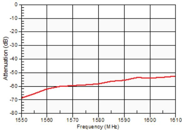
**Figure 35: Band 66 Tx-Ant Attenuation Band 25 Rx, 1930–1995 MHz**
