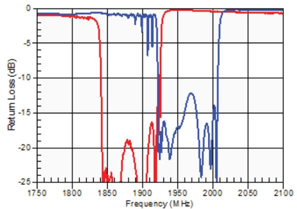
Figure 6: Band 25 Tx-Rx Isolation
