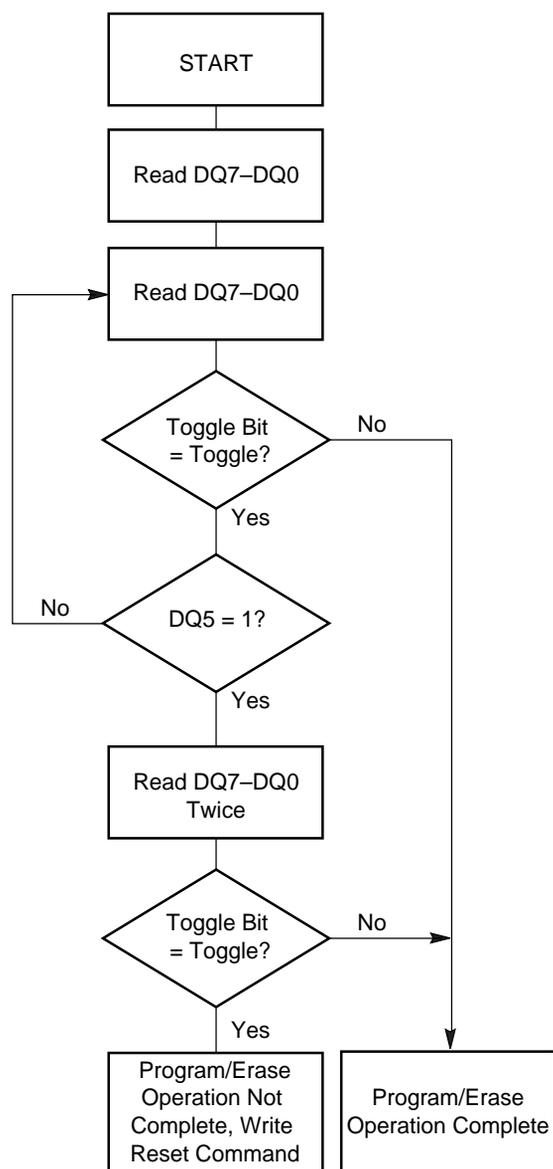
**Note:** The system should recheck the toggle bit even if DQ5 = "1" because the toggle bit may stop toggling as DQ5 changes to "1." See the subsections on DQ6 and DQ2 for more information.
